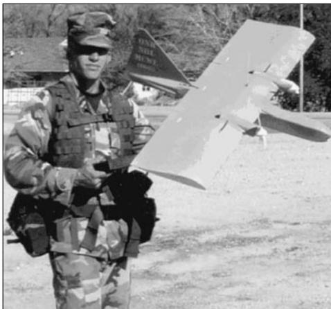
Внешний вид комплекта системы воздушной видовой разведки «Дрэгон Ай»
