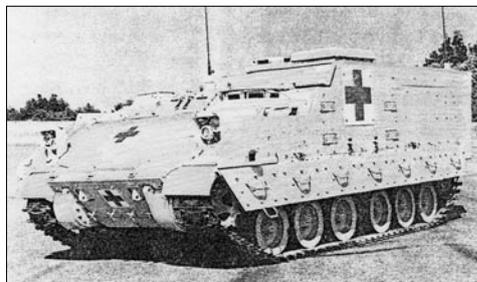
Рис. 2. Бронированная медицинская машина на шасси БМП «Брэдли»
