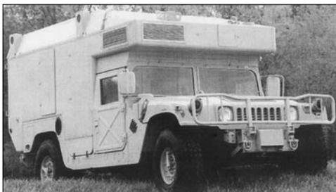
Рис. 3. Санитарная машина M997 на базе армейского автомобиля «Хаммер»
