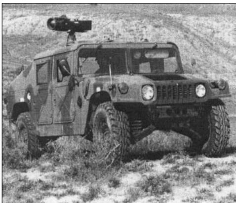
Рис. 2. Оптоэлектронная система разведки «Лоррос», смонтированная на автомобиле типа «Хаммер»
