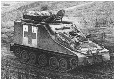
Рис. 5. Санитарно-эвакуационная бронированная машина FW-104 ВС Великобритании
